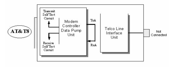
Figure 6 LOCAL ANALOG LOOPBACK WITH SELF TEST
